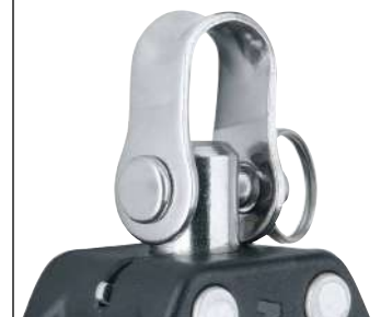
Mando que bloquea el cabezal en dos posiciones fijas; frontal y laterales o dejarlo giratorio, para evitar el retorcido de la línea.
