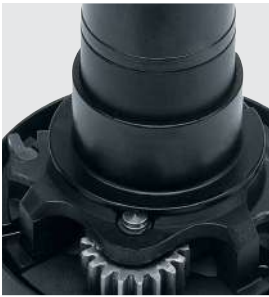
Las series 15 y 20 de winches Radial, utilizan cojinetes de Composite, para retener elevadas cargas con un tamaño pequeño.
