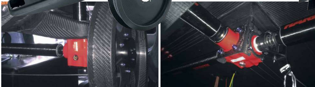
Soporte de cantos redondeados para la caja de Engranajes
