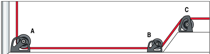
Guiadrizas: Los Guiadrizas especiales sobre cabina (Over-the-Top) son necesarios para dirigir las líneas hacia el exterior de la esquina de la cabina o remontar una brazola.
