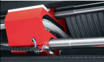
Un guiador de posicionamiento y una roldana aseguran un bobinado suave de a escota sobre el tambor — incluso cuando la línea se afloja.
