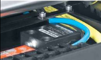
Los interruptores final de carrera, previenen los excesos de recorrido.
